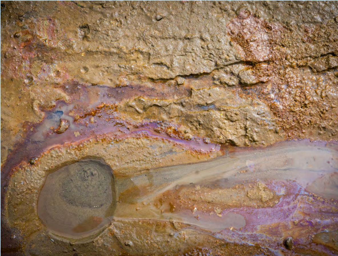
De ontstane pipe (cirkel, bovenaan) met resten kleurstof ter tracering
